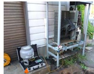
充填ガス量測定機(正確に自動充填)
