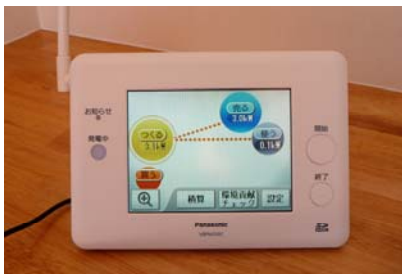
電力モニター
