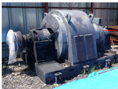
H 社 撤去高圧モーター (3KV-1000 k w)
