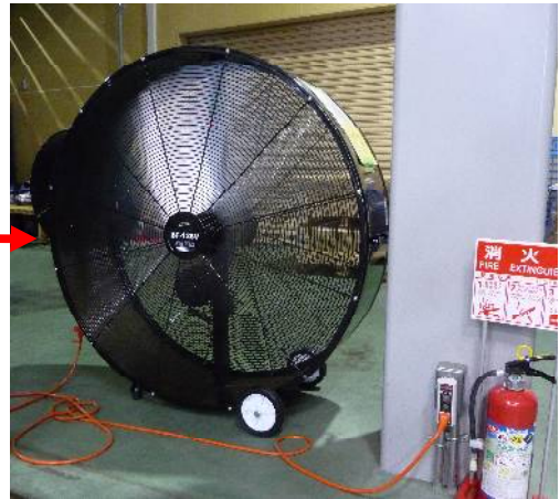
大型送風機 100V、125cm4 枚羽、555W、50kg
